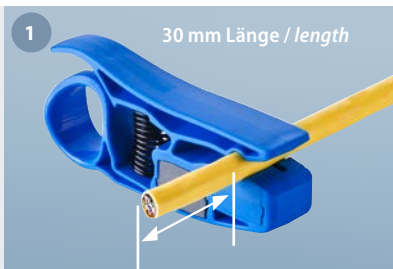
1 Kabelmantel ca. 30 mm absetzen. Strip the outer sheath approx. 30 mm.
